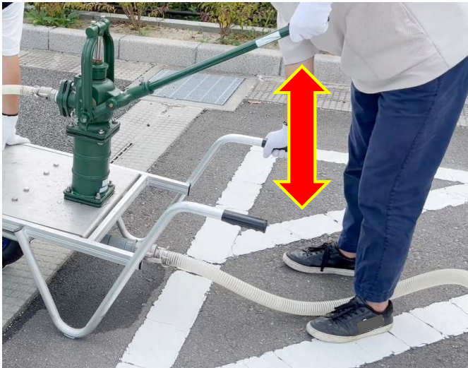
⑦吐き出し用ホースから水が出るまでポンプのレバーを上下する
